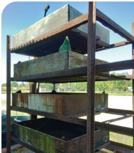
**Gambar 5.1:** Sistem penapisan ferum menggunakan habuk kayu di MARDI Bachok, Kelantan
