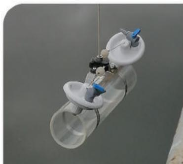
**Gambar 3.4:** *Depth sampler* diturunkan secara berhati-hati ke dalam badan air dengan hujung penutupnya terbuka
