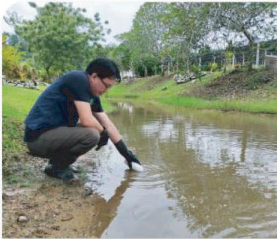
**Gambar 3.2:** Pengambil sampel mengarahkan mulut botol sampel menghadap arus aliran air sungai
