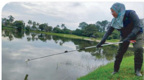
**Gambar 3.3:** Pengambilan sampel air menggunakan *long rod water sampler*
