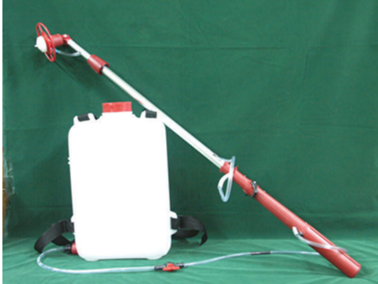
Penyembur isipadu ultra rendah ( Ultra low volume sprayer )
