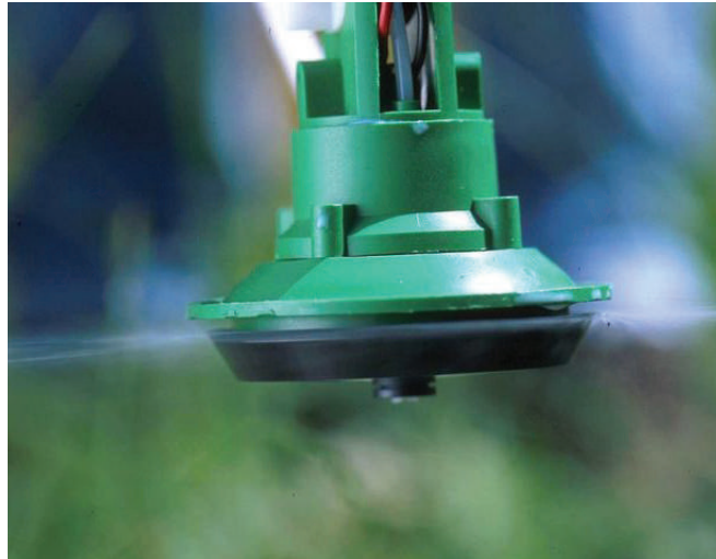
Spinning disk yang akan berputar laju untuk menyebarkan titisan semburan yang halus
