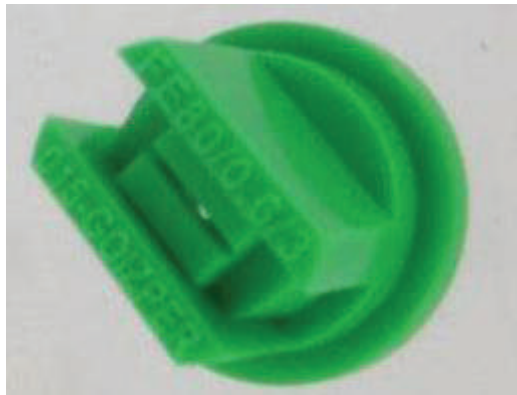
Nozel Flat Even 80/0.6/3 mengeluarkan semburan pada 80° dengan pengeluaran 0.6 liter seminit pada tekanan 3 bar (43.5 psi).
