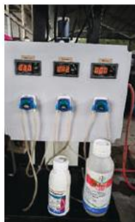
Sistem IOT bagi penyemburan racun di ladang secara automatik
