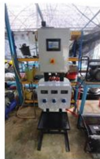
Sistem IOT bagi penyemburan racun di ladang secara automatik
