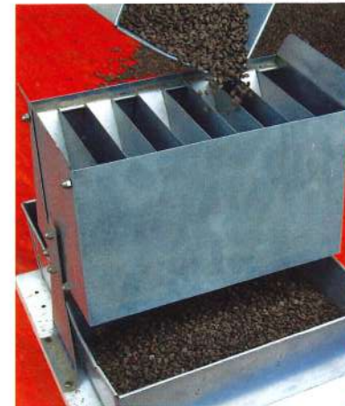
Gambar 36: Kaedah Persampelan menggunakan "soil divider"
