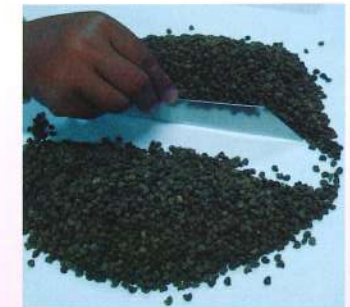
Gambar 37: Kaedah persampelan menggunakan teknik penseparuhan terubah suai
