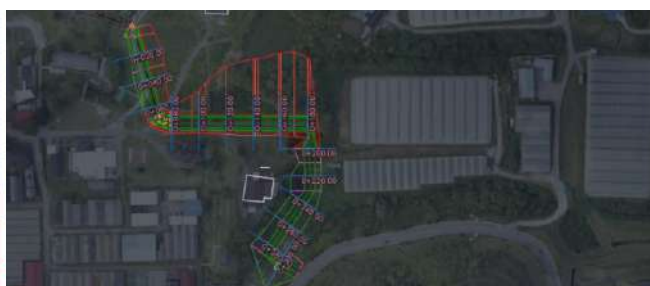
Analisa keperluan isipadu cut-fill - Kawasan merah merupakan lokasi cut-menggunakan aplikasi Autodesk Civil3D.
