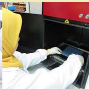
Pengimejan dan dokumentasi asid nukleik dan protein menggunakan GelDoc system.
