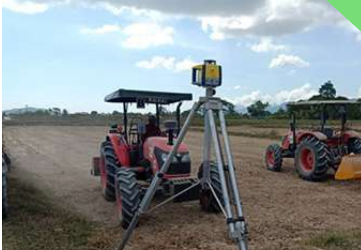
Kelengkapan alat transmitter (tripod) dan receiver (pada implement traktor) digunakan untuk melaraskan tanah di dalam petak sawah
