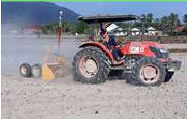
Kerja Perataan Tanah Menggunakan Land Laser Leveller
