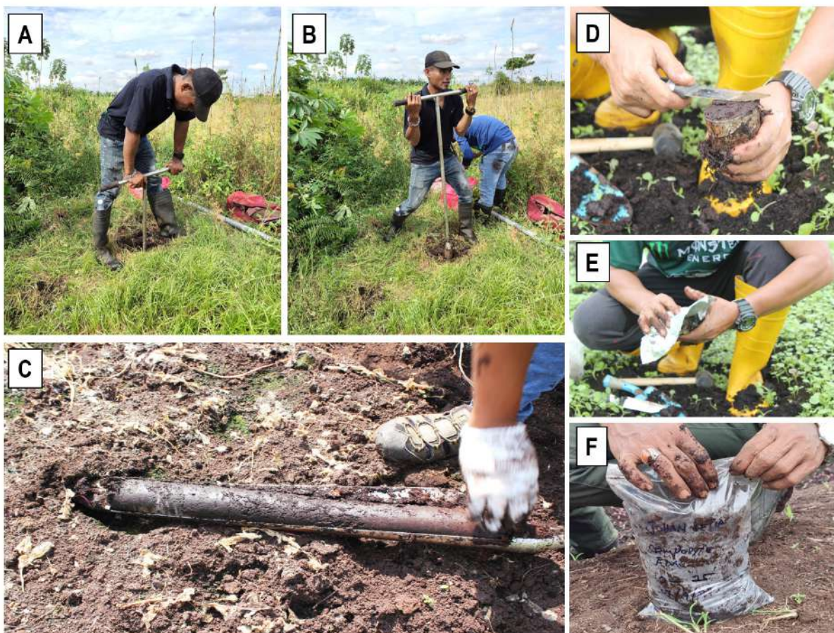
Rajah 2.3: Pensampelan tanah gambut di lapangan untuk ujian makmal: (A-C) kaedah penggunaan peat auger untuk menggali ke dalam tanah dan mengambil sampel tanah, (D-E) kaedah penggunaan pisau/penyodok kecil bagi mendapatkan sampel tanah bagi ketumpatan pukal dan (F) beg sampel digunakan untuk mengisi sampel tanah untuk dianalisis di makmal.
