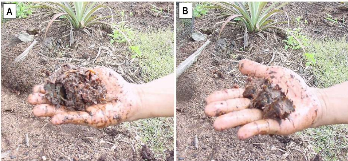
Rajah 2.2: Rubbing and Squeezing Test bagi penentuan pengelasan tanah gambut awal di lapangan: (A) sebelum digenggam dan (B) selepas digenggam.
