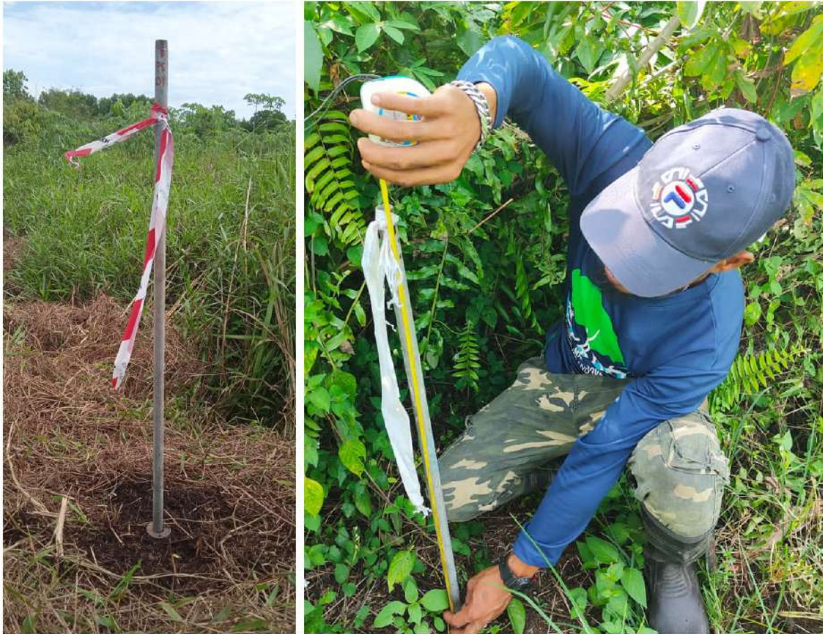
Rajah 4.6: Pemasangan penanda penyusutan tanah gambut di kawasan pertanian untuk memantau dan merekodkan penyusutan tanah gambut.
