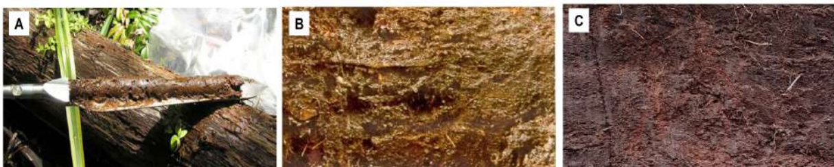
Rajah 2.4: Pengelasan tahap pereputan tanah gambut yang terdiri daripada (A) Fibrik, (B) Hemik dan (C) Saprik.
