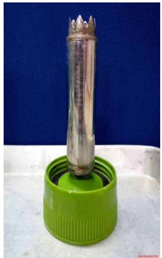
Modifikasi Mata Pemotong Mesin Pengisar (Mata pemotong asal)
