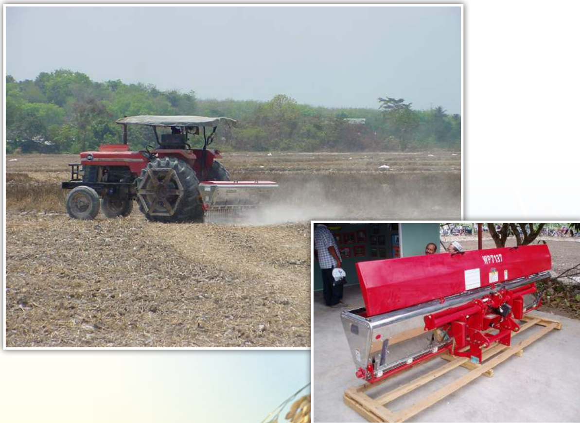
Gambar 14 : Pengapuran menggunakan peralatan Lime Sower
